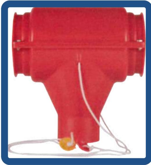
Las bocas en caída son las piezas que permiten que el alimento caiga desde una línea principal de distribución hasta los comederos. Su diseño en T permite una distribución eficiente, dirigiendo el alimento a través de un bajante hacia los puntos de entrega.
